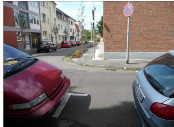
Mangelhafte Sichtbeziehungen an einer empfohlenen Überquerungsstelle
