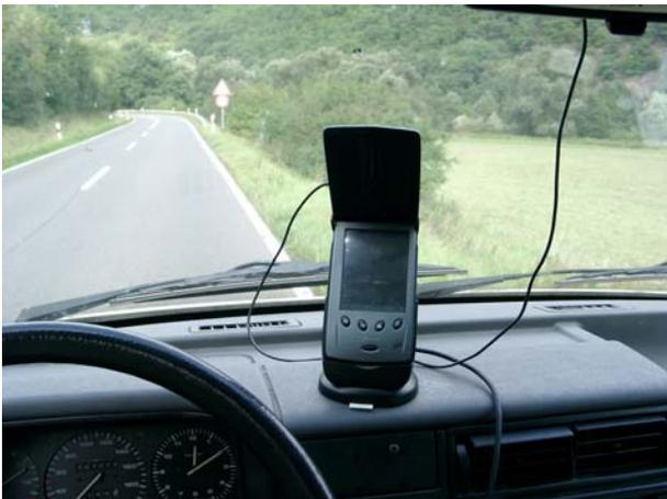
Abb. 4-4 GPS-Gerät im Fahrzeug
