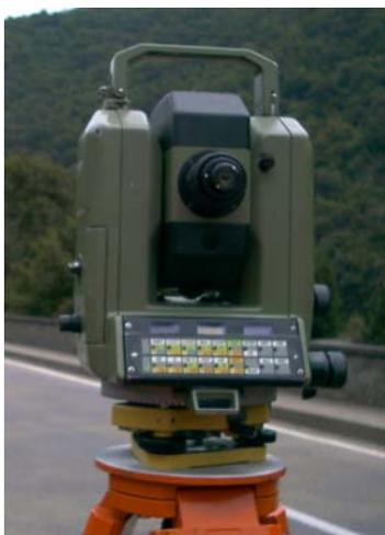
Abb. 4-1 Verwendetes elektronisches Tachymeter
