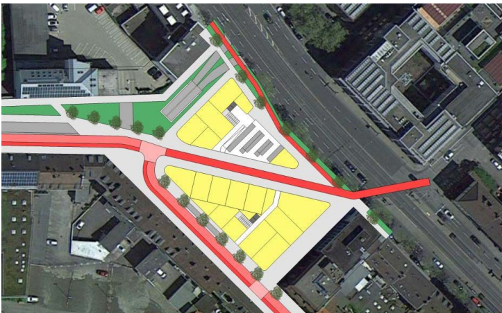
ABBILDUNG_15 | Entwurf für den Neubau des Parkhauses „Gare du Corps“ in der Fünfensterstraße mit diagonalem Radweg quer über das Gelände als optimale Verbindung mit der Innenstadt (Draufsicht).
